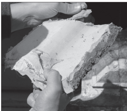
Fot. 3. a) Wspornik balkonu po zdemontowaniu elementu sztukatorskiego źle umocowanego do konstrukcji, b) Fragment sztukaterii kruszący się w rękę
