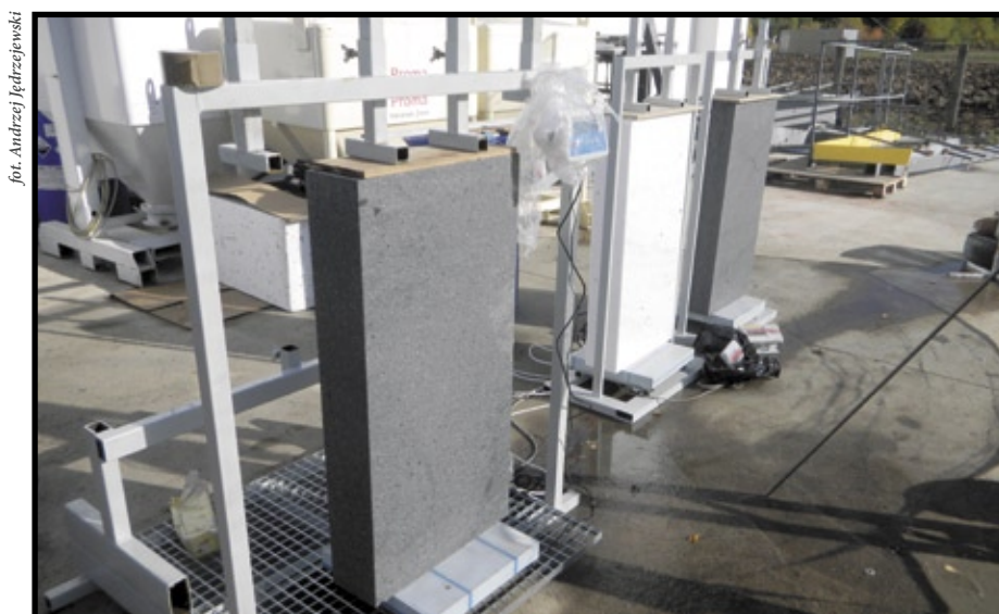
Fot. 5. Zestaw stanowisk polowych do równoczesnego badania siły oddziaływania rozszerzających się styropianów białego i szarego, z możliwością uwzględnienia osłony rusztowaniową siatką ochronną
