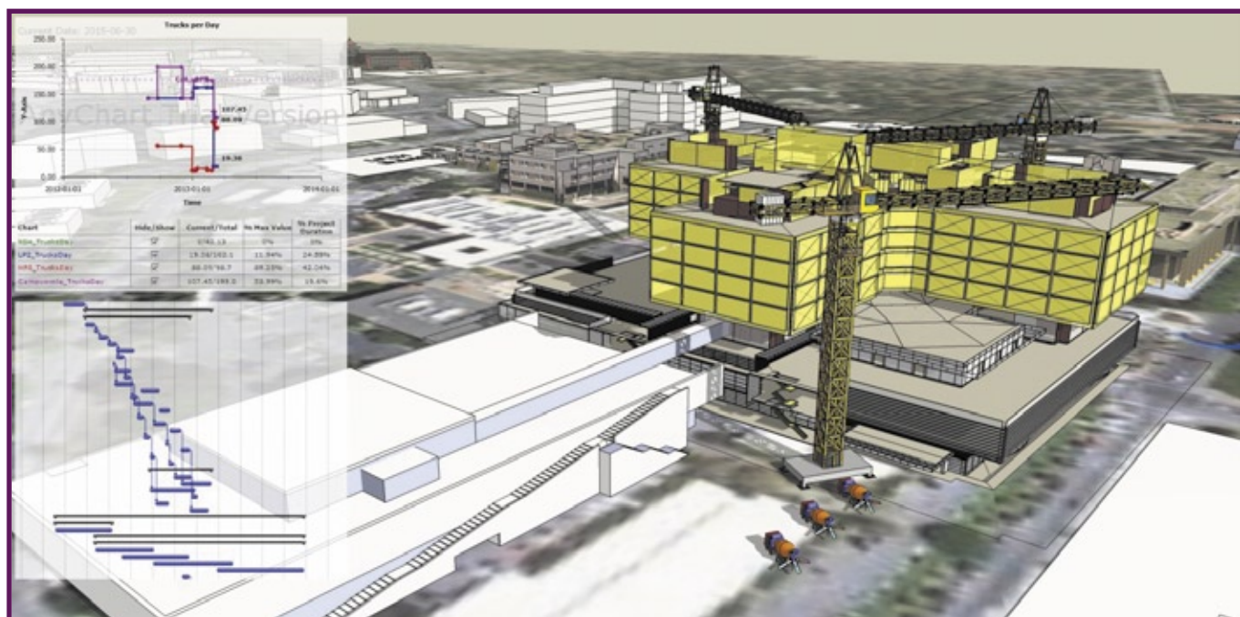
Interfejs programu SketchUP 4D Virtual Builder pokazujący plac budowy oraz miejsce w harmonogramie odpowiadające temu stanowi zaawansowania prac
