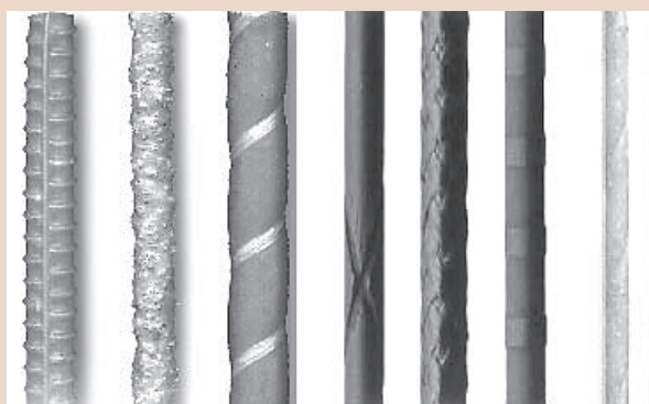
Rys. 3. Pręty kompozytowe wykonane z różnych typów włókien [3]
