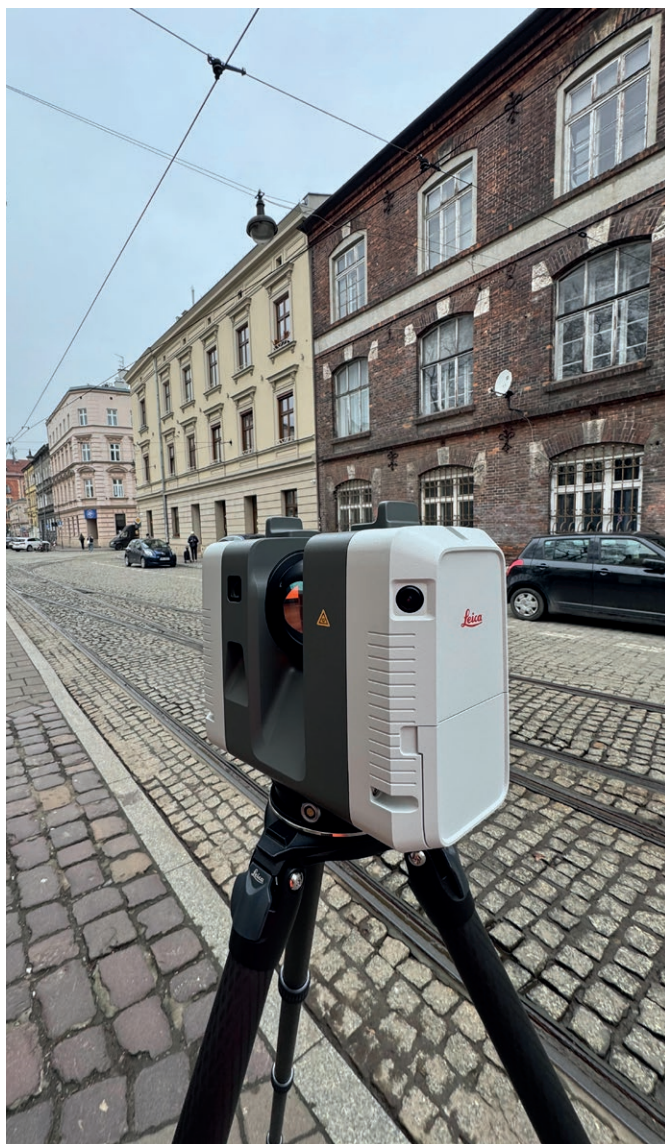
Rys. 1. Wykonywanie inwentaryzacji skanerem laserowym – inwestycja niepowiązana. Fot. Jan Pilarski
