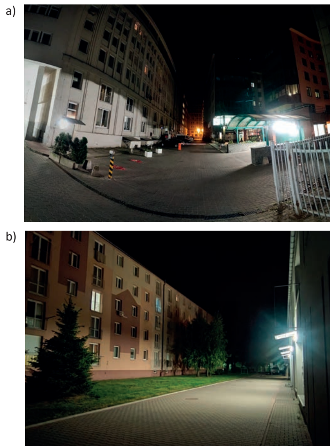
Rys. 2. Przykład oddziaływania oświetlenia zewnętrznego budynku na sąsiednią zabudowę mieszkaniową: a) oświetlenie wjazdu do garażu podziemnego, b) oświetlenie ciągu pieszego
