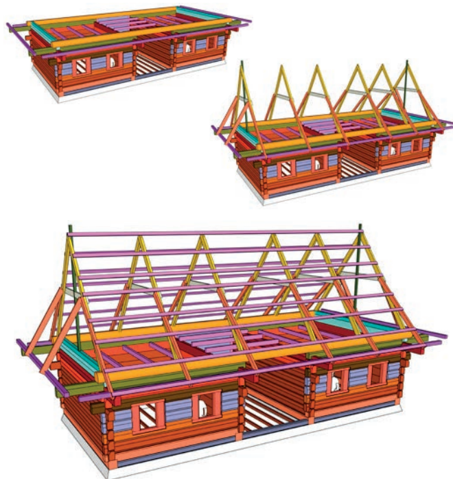
Etapy konstruowania więźby. Źródło: opracowanie własne
